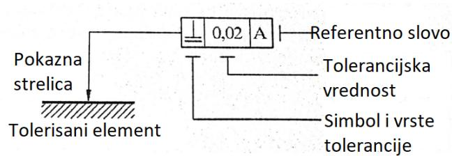
Pokazna strelica se postavlja na tolerisani element. Okvir može biti podeljen dva ili tri polja, u prvo polje okvira upisuje se simbol vrste tolerancije. U drugi deo polja upisuje se tolerancijska vrednost. Referentno slovo upisuje se u treće polje okvira. Znak za pokazni element sastoji se od okvira i referentnog trougla spojenih linijom. U okvir se upisuje referentno slovo, referentni trougao se postavlja na polazni element.
