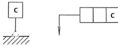
Referentna površina je površina C i upisuje se u treće polje, dok je simbol za upravnost  $\perp$  koje se unosi u prvo polje, dok se u drugo unosi vrednost tolerancije 0.4, na slici je dat prikaz tolerancije oblika i položaja.
