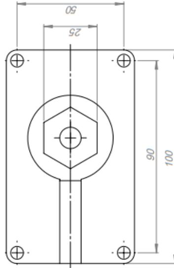
Na slici je dat prikaz nepravilnog kotiranja
